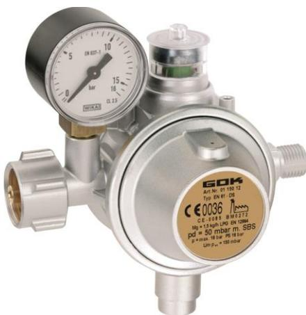
Abb. 12: Zweistufiges Druckregelgerät für den Gewerbebereich mit Überdrucksicherheits-einrichtung, Sichtanzeige und integrierter Schlauchbruchsicherung (Quelle: Fa. GOK, [www.gok-online.de](http://www.gok-online.de))
